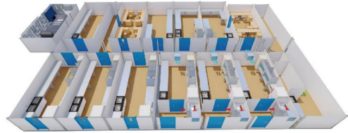
共享实验室(示例) (D级, 每间21m2) Shared Lab (example)(Class D, 21m2 per room)
